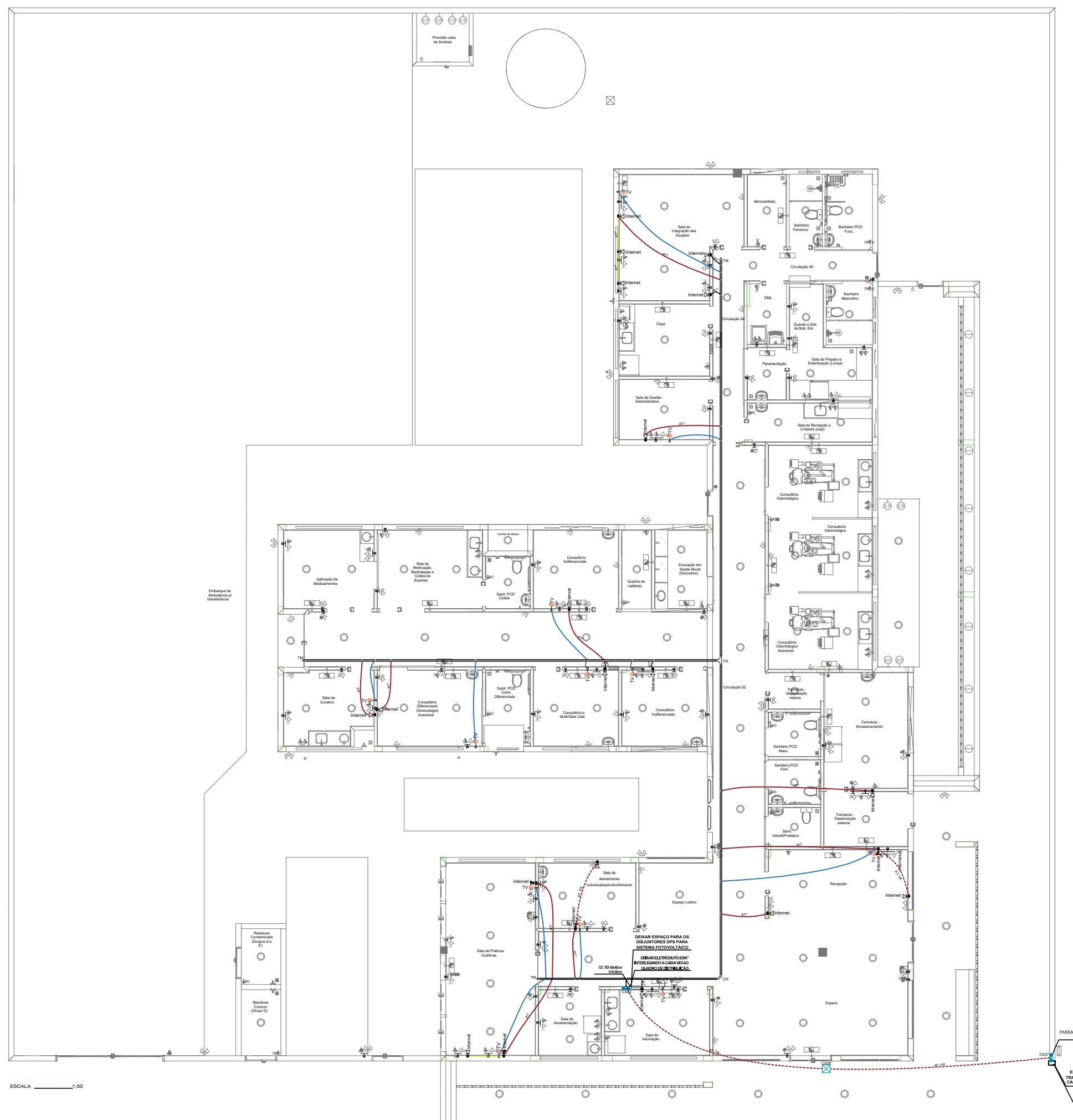
OBSERVAÇÃO : \* O TRAJETO DOS PAINÉIS SOLARES SAINDO DO MEDIDOR (BIDIRECIONAL) E INDO ATÉ A COBERTURA SERÁ TRACADO EM OBRA. ESCOLHER O MELHOR TRAJETO PARA CUSTO BENEFÍCIO \* DEIXAR ESPAÇO PARA DISJUNTORES DPS PARA SISTEMA FOTOVOLTAICO \* O PONTO DE TV SOBE ATÉ A COBERTURA
